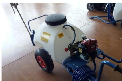
Un modèle proposé par les établissements Nova à Oraison, pour à peine plus de 1000 €, tout à fait adapté aux oliviers avec sa cuve de 80 l, un petit moteur fiable et une lance classique.
